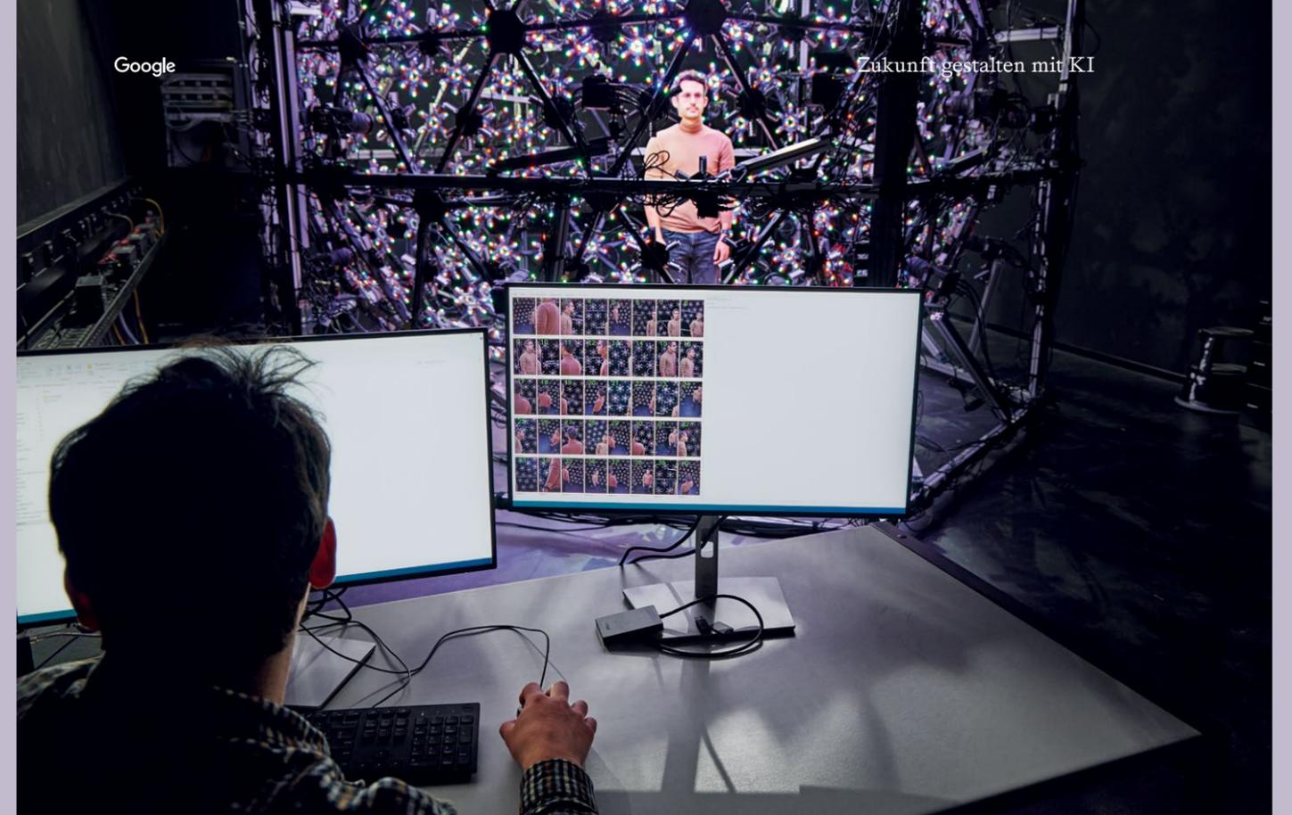
Aus jedem Winkel: 40 Kameras erfassen in der Lightstage Testpersonen. Die Aufnahmen lassen sich mithilfe von KI in dreidimensionale digitale Abbilder umwandeln
