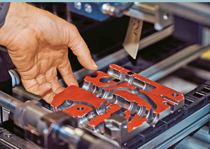
Dieses Schnittmodell veranschaulicht die Komplexität eines Traktorventils.
